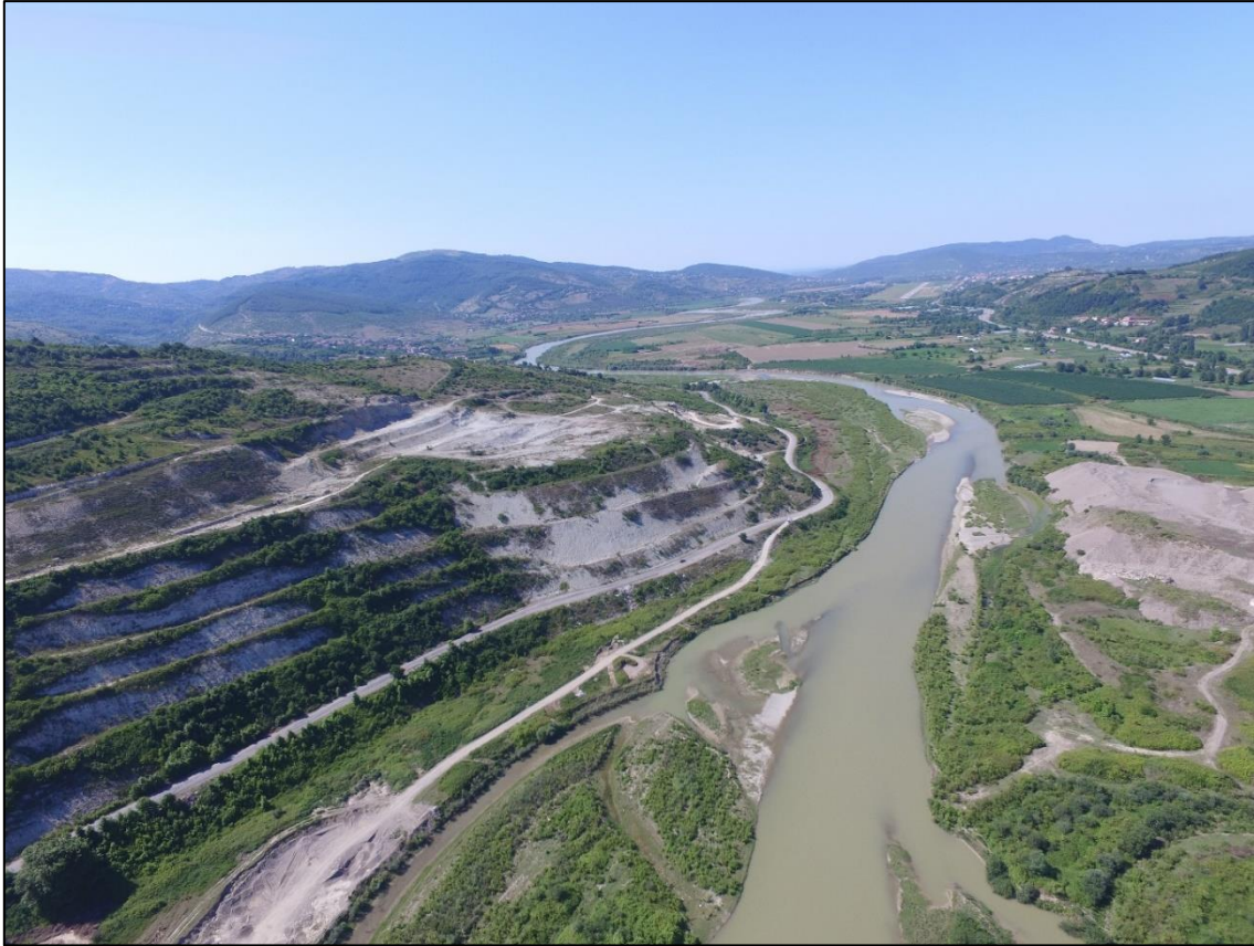
Fotoğraf 1. Zonguldak Havalimanı pistinin 2,6 km güneyinde bulunan Kıranburnu Tepesi (235,4 m), uçakların kalkış ve inişine engel teşkil ettiği için tıraşlanmıştır. Kaynak: Yazarların arşivinden.
